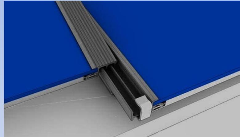
Delle apposite guarnizioni tra un modulo e l'altro garantiscono la tenuta all'acqua come un normale manto di copertura. Si prevede pertanto la posa di una guaina o di una barriera al vapore
